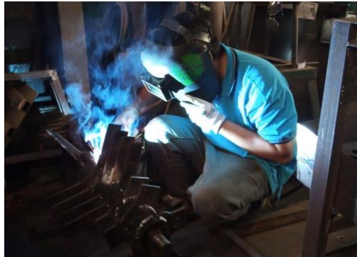
Gambar 6. Proses manufaktur bagian pencacah Sumber data : Pengamatan lapangan
