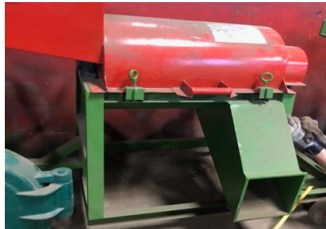
Gambar 3. Mesin alat pencacah pupuk organik Sumber data : pengamatan lapangan
