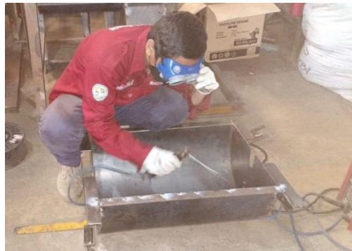
Gambar 13. Proses manufaktur bagian kap dan corong masuk Sumber data : Pengamatan lapangan
