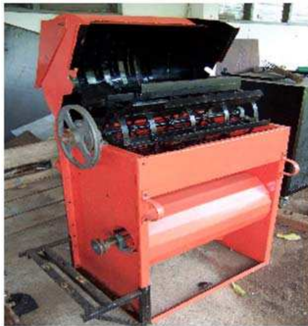
Gambar 3. Mesin perontok sorgum hasil modifikasi. Sumber : Firmansyah et al. (2003)
