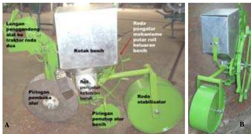
Gambar 2. Alat tanam biji sorgum rolling injection planter (A: tampak samping, B: tampak belakang)
