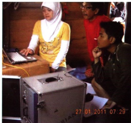
Gambar 11. GRK dianalisis menggunakan Mobile GC.
