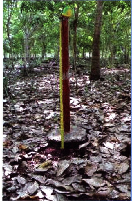
Gambar 37. Subsiden gambut di kebun karet terpelihara, 25 m dari Sungai Jabiren (Oktober 2012).
