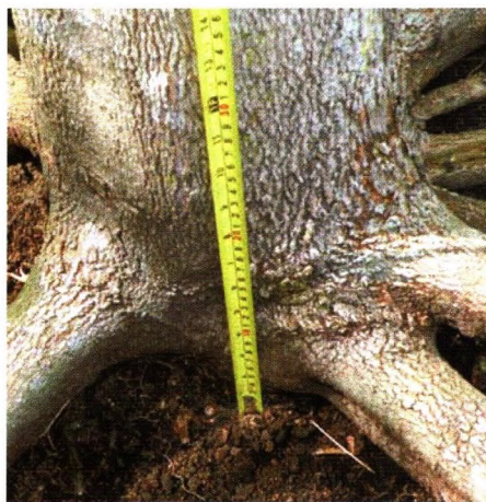
Gambar 35. Terjadi penurunan permukaan tanah gambut 20 cm dari pangkal tanaman karet.
