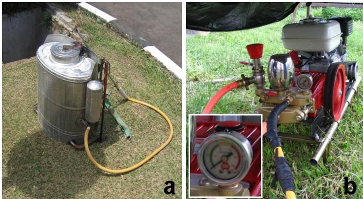
Gambar 48. Alat semprot pestisida : penyemprot punggung (a) dan power sprayer (b). Insert : alat pengukur tekanan semprot (manometer) (Foto : Tonny K. Moekasan)
