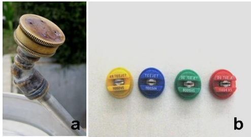
Gambar 47. Nozzle atau spuyer : nozzle holocone 4 lubang (a) dan nozzle kipas (b) (Foto : Tonny K. Moekasan)
