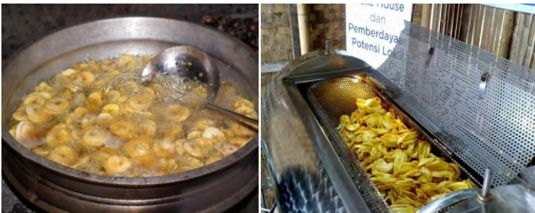
Gambar 2. Proses pembuatan keripik buah secara tradisional dengan deep frying (kiri) dan pembuatan keripik buah dengan menggunakan vacuum frying (kanan)
