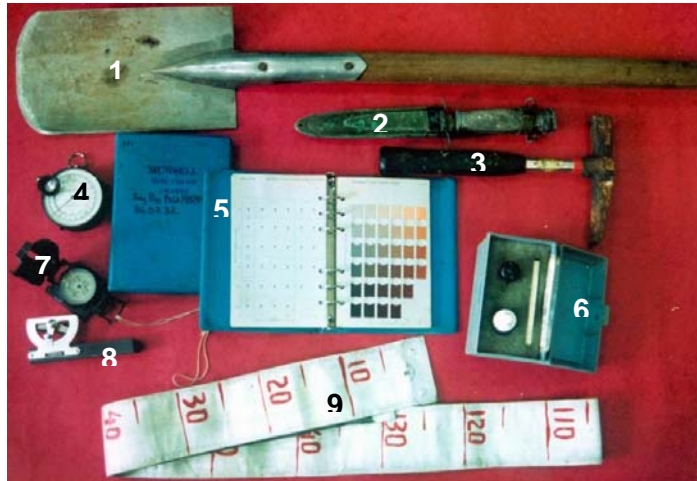
Gambar 3.1. Peralatan untuk persiapan pengamatan tanah (1= sekop, 2= pisau belati, 3= palu geologi, 4= altimeter, 5= munsell soil color chart, 6= pH Truogh, 7= kompas, 8= abney level, 9= meteran ban).
