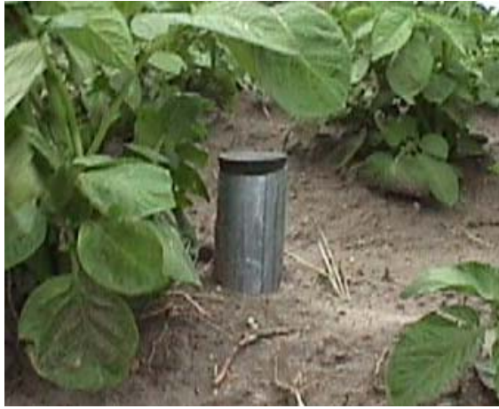
Gambar 4. Tabung akses dari aluminium dengan penutup dari kepingan karet
