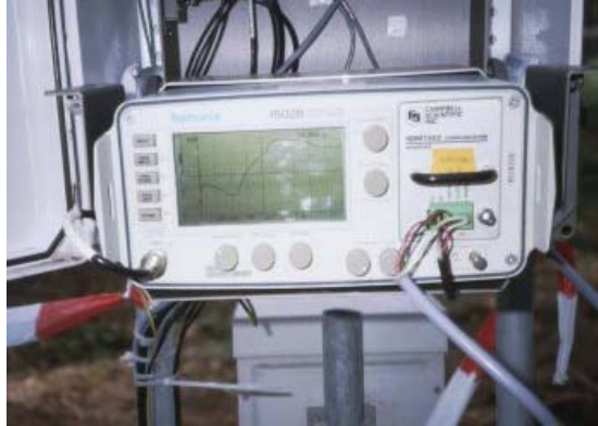
Gambar 1. TDR dengan signal pada layar
