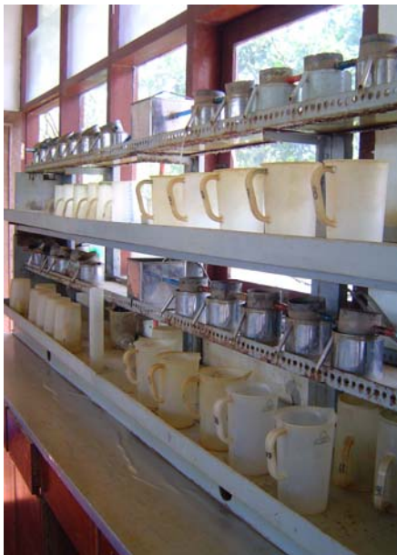
Gambar 1. Alat pengukur konduktivitas hidrolis (permeabilitas) tanah dengan sistem pembuangan air satu arah (Foto: Sutono; Gambar: Marwanto)
