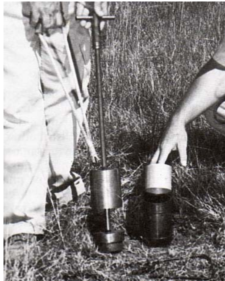
Gambar 2. Uhlund sampler (Dari Blake dan Hartge, 1986)
