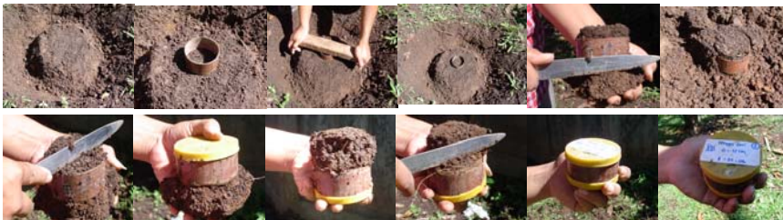
Gambar 5. Tahapan-tahapan pengambilan contoh tanah utuh menggunakan ring kuningan (bergerak dari pojok kiri atas ke pojok kanan bawah)
