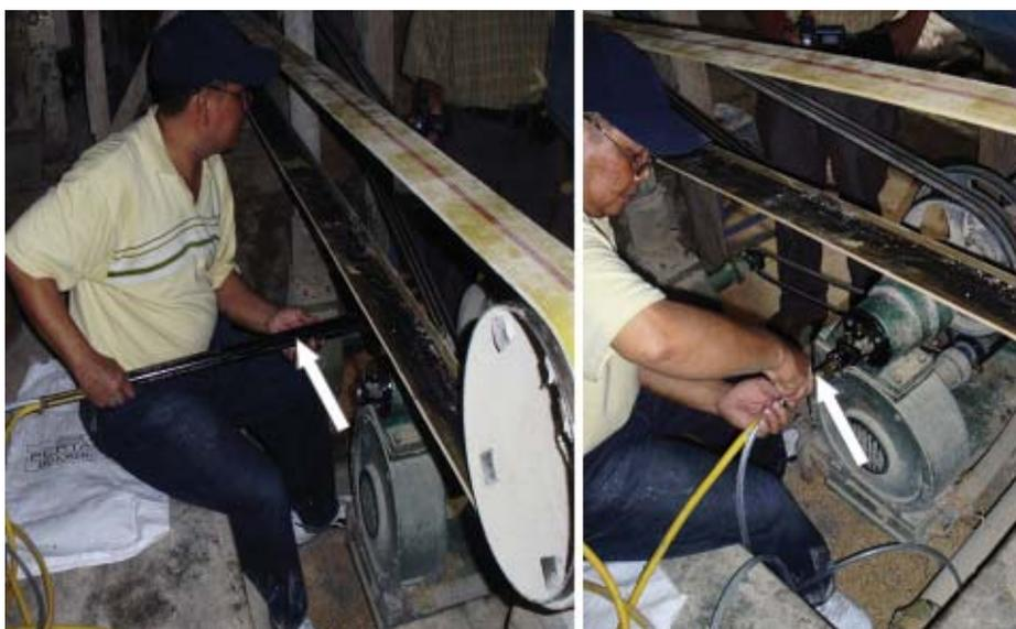
*Gambar 2. Pemasangan alat pengabut air tipe bayonet (ditunjuk tanda panah) pada mesin penyosoh beras di Pariaman, Sumatera Barat.*
