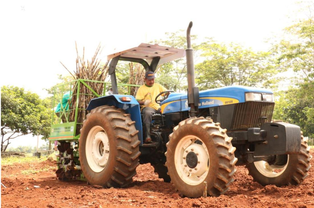
Gambar 7. Kegiatan pengujian kinerja mesin mesin tanam tebu kombinasi pemupuk dan pemasang irigasi tetes di Kebun Percobaan BBP Mektan
