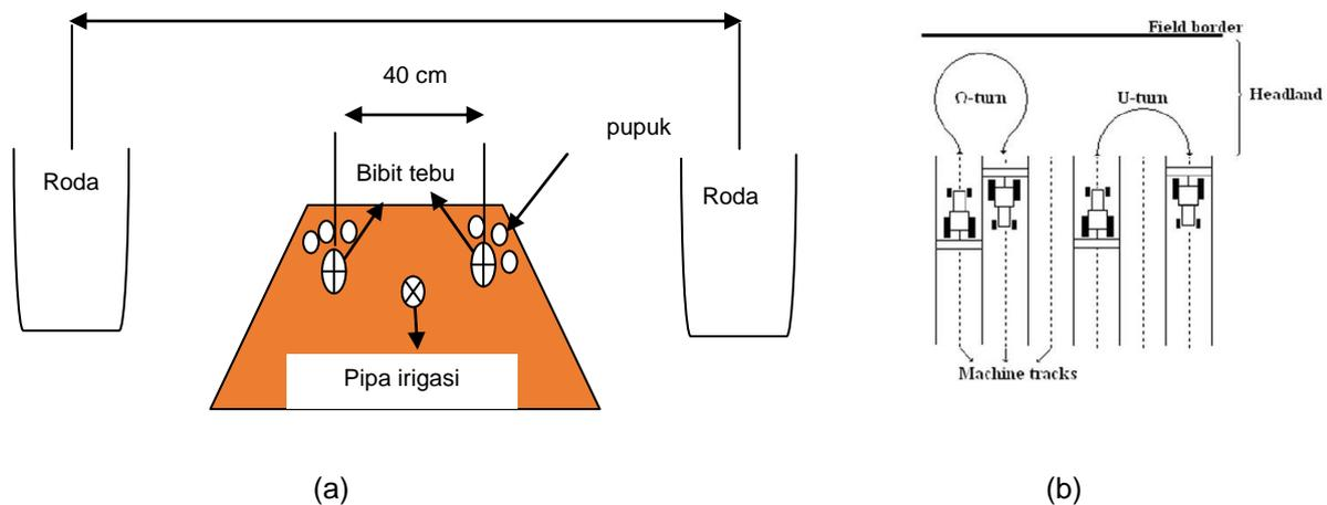
Gambar 6. Pola Tanam (a) dan ilustrasi peletakan bibit tebu, pupuk dan selang pipa irigasi (b) Hasil uji kinerja mesin tanam tebu (*planter*), pemupuk dan pemasang pipa irigasi tetes
