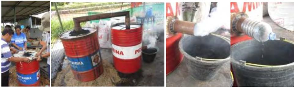
**Gambar 1. Instalasi tungku sederhana untuk menghasilkan asap cair**
