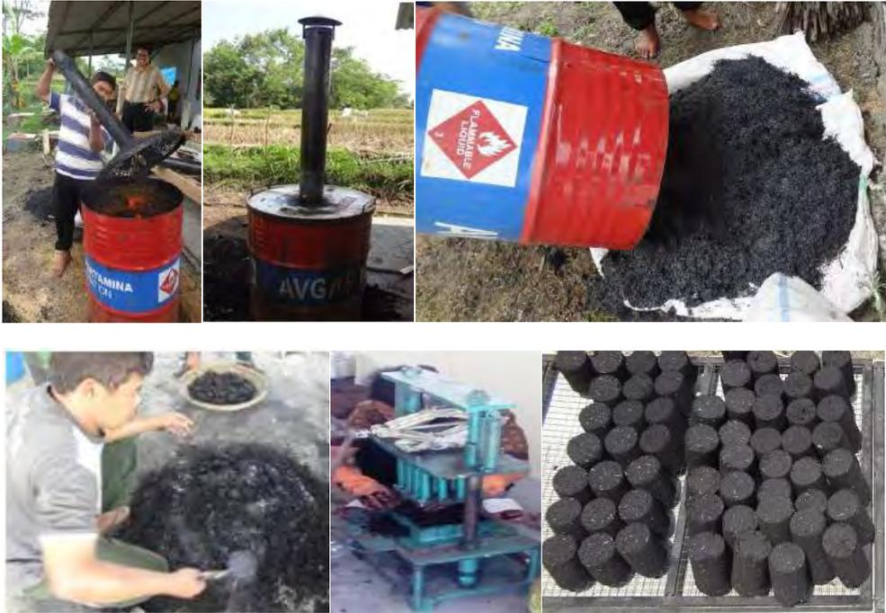
**Gambar 1. Proses pembuatan briket arang**
