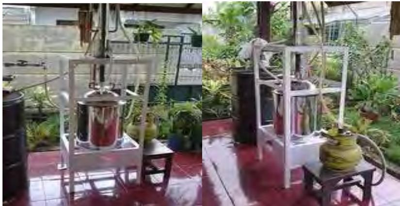
**Gambar 8. Penyulingan (distilasi) ethanol menggunakan distillator model kolom reflux**
