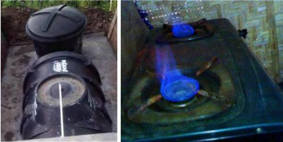
**Gambar 9. Instalasi pemroses limbah kandang ternak menjadi biogas (kiri) dan contoh pemanfaatan biogas sebagai sumber energi (kanan)**
