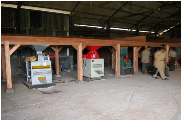
Gambar 16. Mesin Pengupas Kulit Gabah
