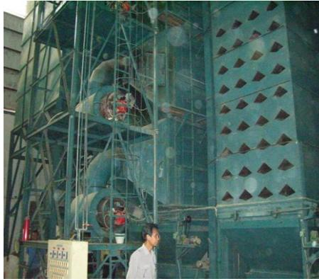
Gambar 13. Pengeringan padi dengan *continuous flow dryer*
