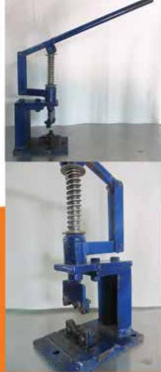
Alat ini merupakan penyempurnaan dari alat pengupas kulit biji jambu mete yang dikembangkan oleh Universitas Khon Kaen dari Thailand model AE (KKU) 2. Perbedaan prinsip alat ini dengan model AE (KKU)2 terletak pada mekanisme tekan puntir, model unit pisau bawah dan pisau atas, serta pengatur posisi gelondong.
