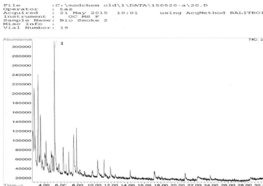
Gambar 3. Kromatogram biosmoke menggunakan GC-MS
