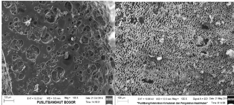
Gambar 2. Foto SEM dari biochar cangkang biji jambu mete dengan ukuran besar (A) dan ukuran kecil (B)
