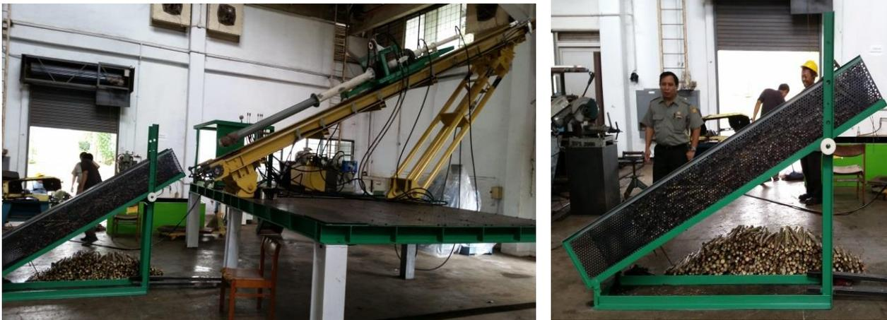
Gambar 3. *Core sampler* dan dudukan tebu siap giling untuk keperluan uji di BBP Mektan
