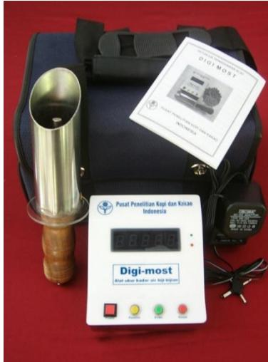
**Gambar 7. Alat Pengukur Kadar Air Biji Kakao**
