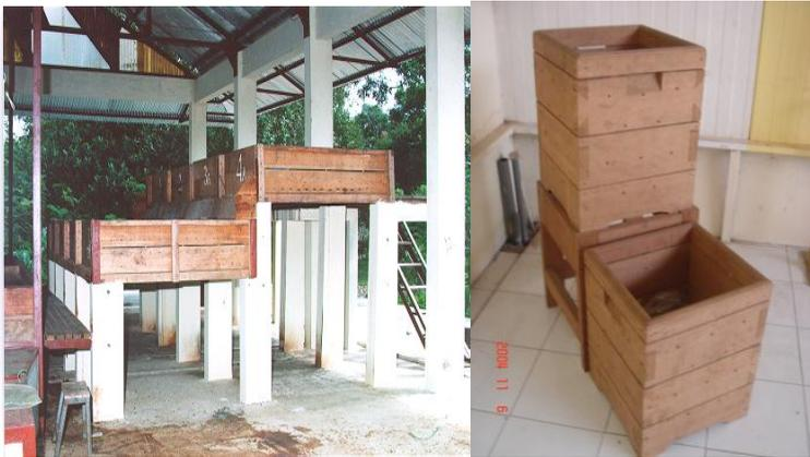
**Gambar . 2. Peti Fermentasi Kayu kapasitas 650 Kg (kiri ) dan kapasitas 40 kg (kanan)**
