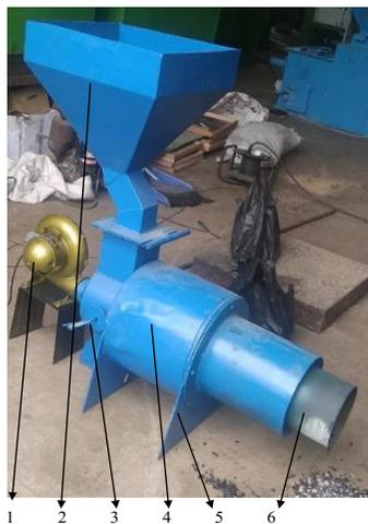
Gambar 5. Mesin Tungku berbahan bakar biopellet
