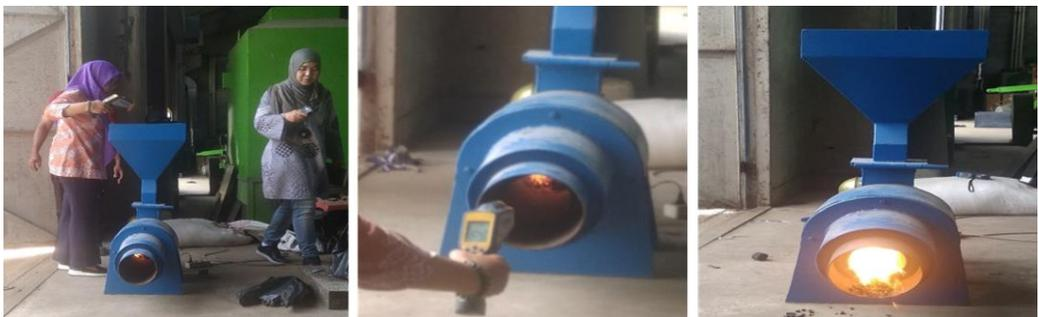
Gambar 7. Pengujian tungku berbahan bakar biopelet sekam
