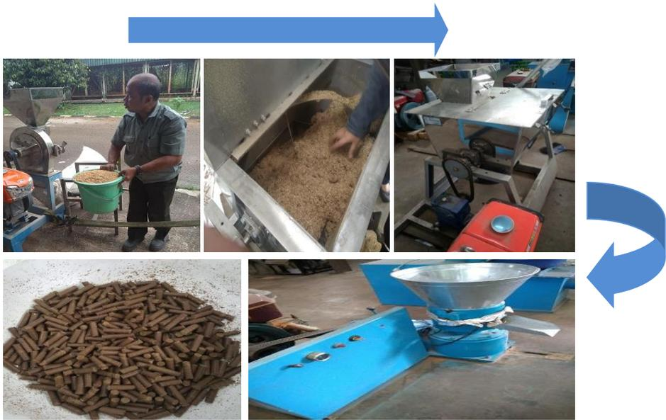
Gambar 6. Proses pencetakan biopelet sekam
