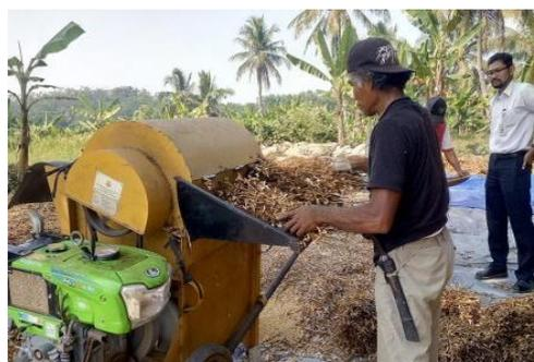
Gambar 11. Proses Perontokan Biji Menggunakan *Thresher*
