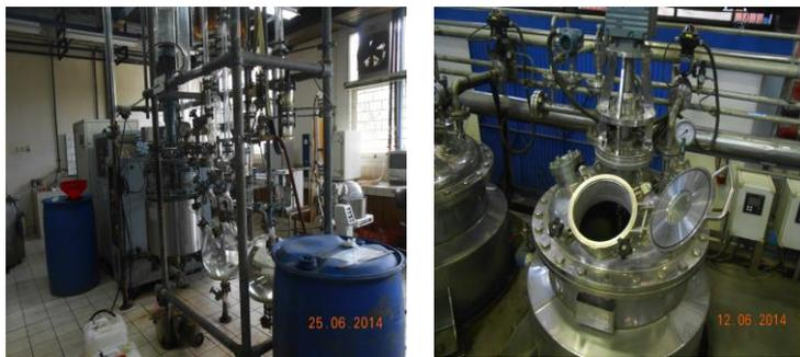
Gambar 16. Peralatan untuk delignifikasi sekaligus hidrolisis awal dengan NaOH
