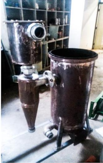
Gambar 23. Filter pendingin dan penyaring gas
