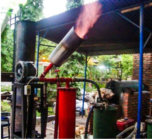
Gambar 32. Gas bakar hasil dari kinerja unit gasifier tipe downdraft
