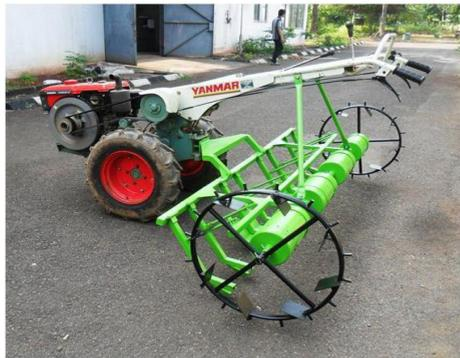
**Gambar 3.** Prototipe Atabela Jarwo 2-1 ditarik traktor untuk lahan pasang surut
