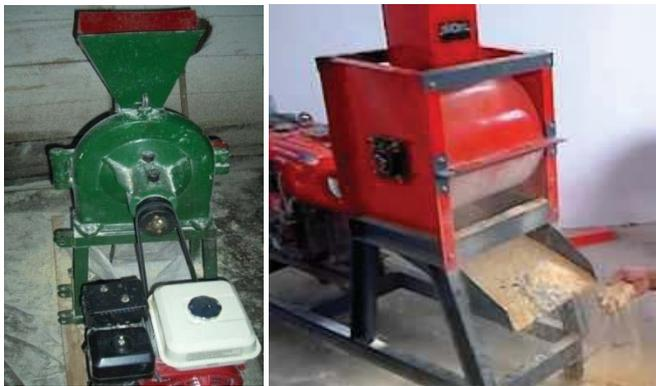
**Gambar 2.** Mesin penggiling jagung tipe *disc mill* (kiri) dan *hammer mill* (kanan)
