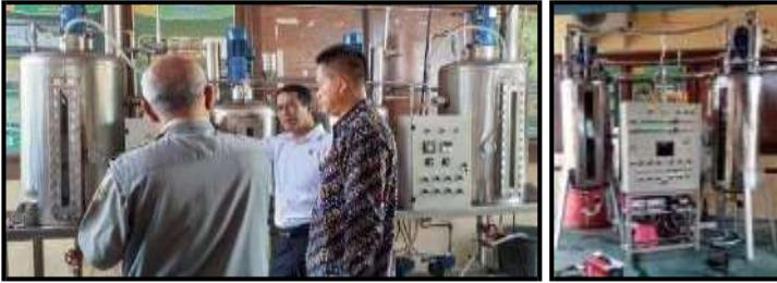
Gambar 26. Kiri: Reaktor multifungsi dengan Sistem Metanol Recovery untuk membuat biodiesel/B100 rekayasa Kementan di Instalasi Bioenergi di Pakuwon; Kanan: Mentan RI saat meninjau pengembangan biodiesel 100% (B100) di Balai Penelitian Tanaman Industri dan Penyegar (Balitri, Sukabumi)
