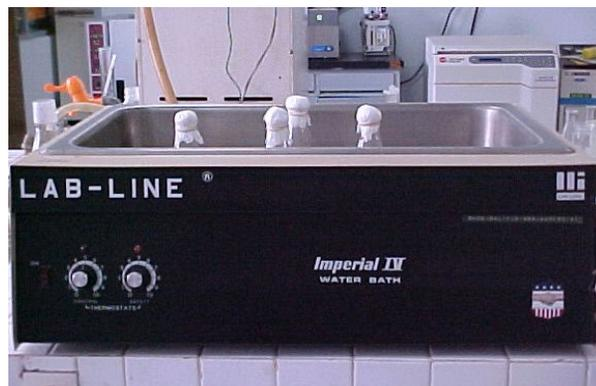
Gambar 1. Inkubator atau penangas air dengan pengatur suhu.
