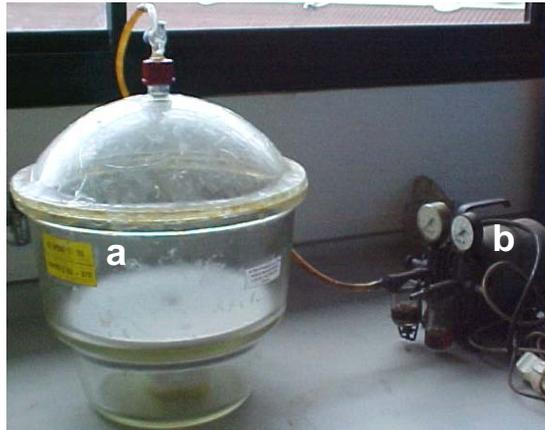
Gambar 1. Desikator (a) dengan pompa penghisap udara (b)
