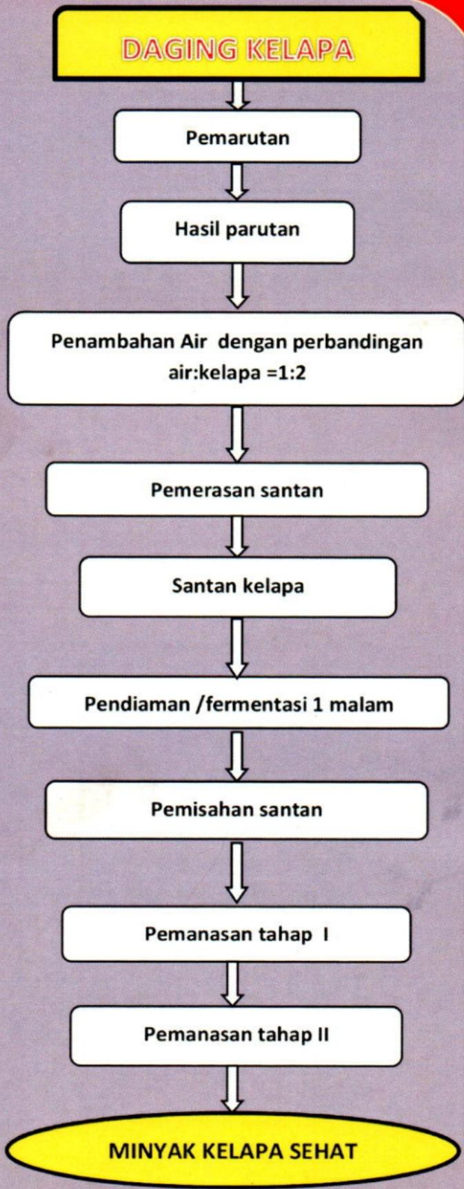
**Gambar 7.** Bagan Alir proses pembuatan minyak kelapa Sehat
