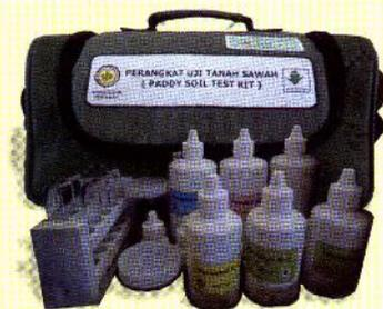
Gambar 5. Boks PUTS Khemikalia untuk Uji Tanah
