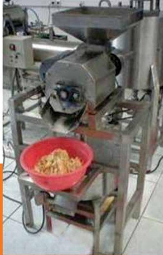
Mesin ini dirancang untuk membubur buah lunak, yang utuh atau sudah dipotong-potong, telah atau tanpa dikupas. Jenis buah yang bisa dibubur jambu biji, mangga, sirsak, jeruk, manggis, srikaya, dan marquisa. Komponennya adalah penampung buah, poros utama, konveyor ulir, sikat, dan penyaring.
