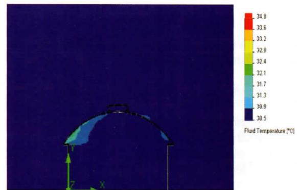
Gambar 5. Distribusi suhu di dalam rumah tanaman pada pukul 08:00 WIB (radiasi matahari 418 W/m<sup>2</sup> dan kecepatan angin 0,5 m/detik).
