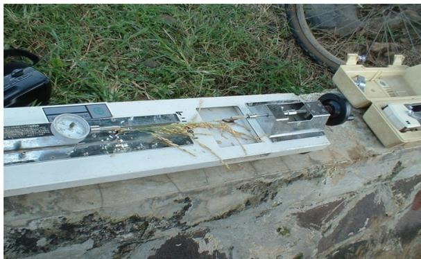
Gambar 7. Alat ukur gaya tarik pelepasan (*Shattering Habit*) Model TR-II
