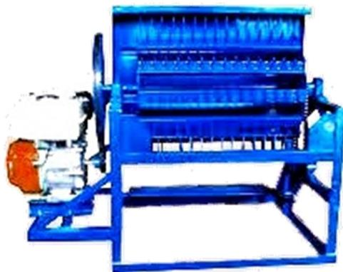
Gambar 2. *Power Thresher* dengan tipe silinder (*silinder*) terbuka
