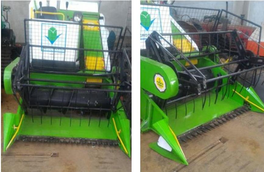
Gambar 3. Hasil modifikasi mesin panen jagung prototipe II, TA 2017
