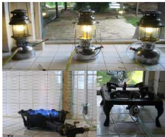
Gambar 5. Penggunaan biogas untuk penerangan dan kompor gas
