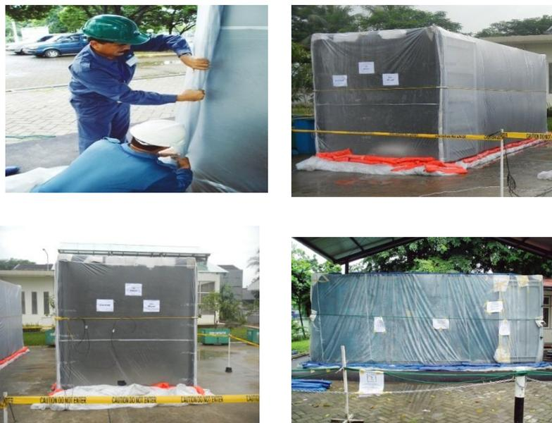
Gambar 6. Pemasangan lembar penutup
