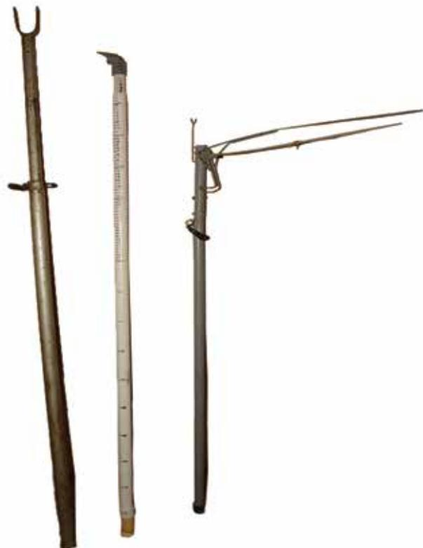
Ide kreatif ini berasal dari pengalaman inventor dalam mengatasi kendala pengukuran tanaman yang tingginya melebihi tinggi pengukur. Alat ini berbentuk tongkat yang terdiri dari tiga bagian yaitu pipa luar, pipa tengah, pipa dalam, dan dilengkapi dengan petunjuk titik ketinggian.
