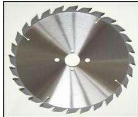
Gambar 2. Pisau potong komersial dengan lapisan *carbide* pada ujung pisau.
