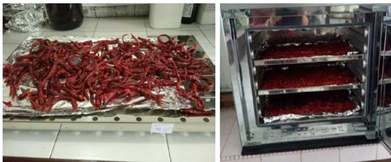
Gambar 13. Cabai dikeringkan menggunakan pengering buatan
