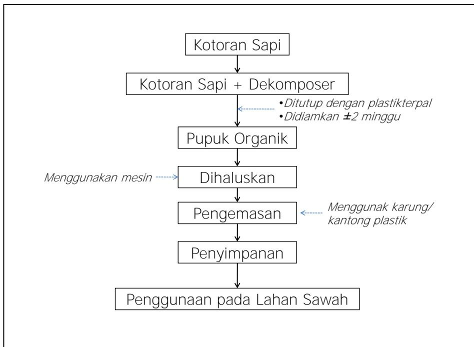
Gambar 32. Tahapan proses pembuatan pupuk organik padat dari kotoran ternak sapi menggunakan dekomposer orgadec
