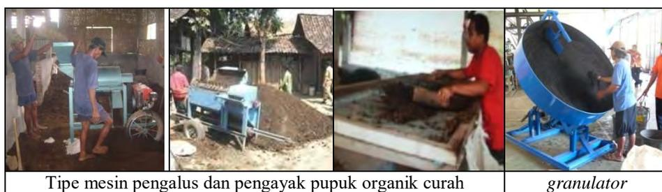
Gambar 30. Mesin penghalus, alat pengayak dan *granulator*
