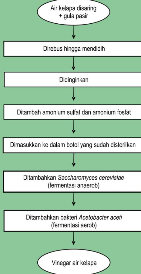
Diagram alir pembuatan vinegar air kelapa
