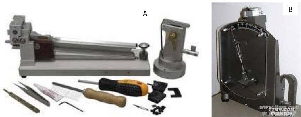
Gambar 5. Alat uji kekuatan serat: a. Presley fiber strength tester dan b. Stelometer
