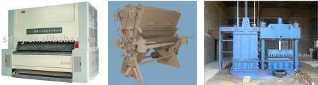
Gambar 3. Mesin pengolah serat kapas: saw gin (kiri), roller gin (tengah), dan pengebal (kanan)
