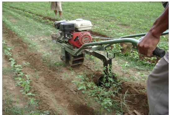
Gambar 2. Pengoperasian mesin penyiangan (Fatah dan Tastra 2007)
