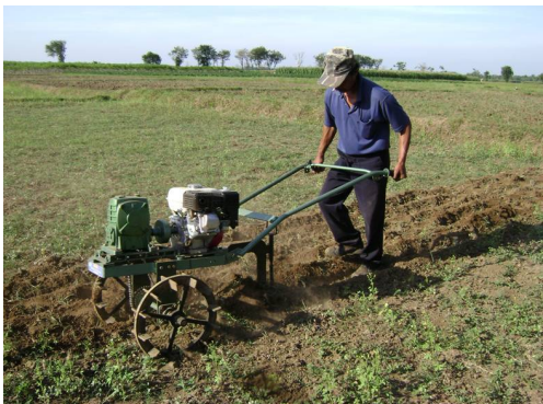
Gambar 1. Pengoperasian mesin pengolah tanah (Fatah dan Tastra 2008)
