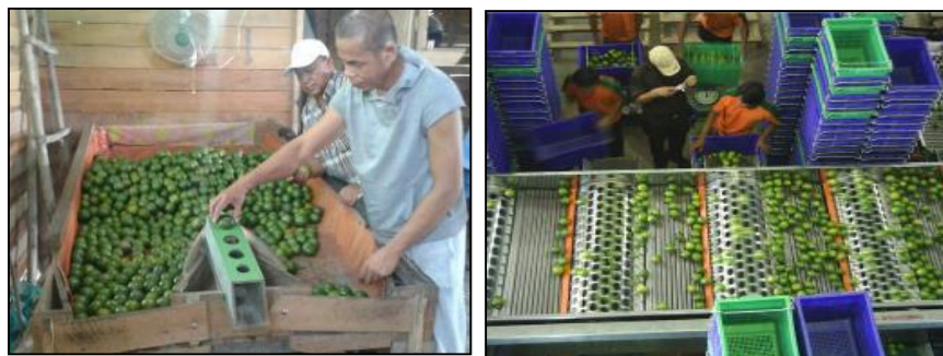
Gambar 2. Grading buah jeruk secara manual dan mekanisasi
