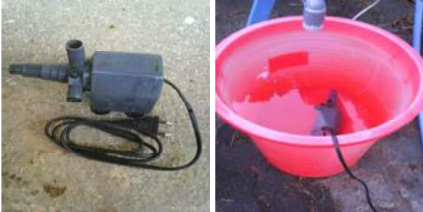
Gambar 7. Pompa Akuarium untuk Mengalirkan Air
