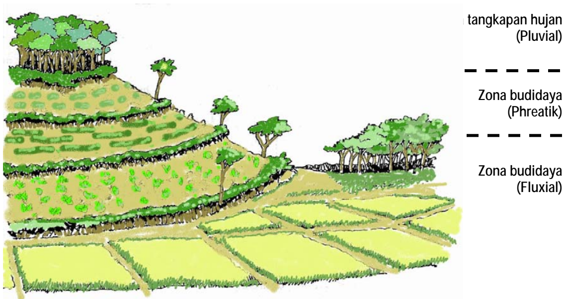
Gambar 2. Ilustrasi toposekuen suatu DAS yang menunjukkan keterkaitan antara DAS hulu, tengah, dan hilir (modifikasi dari information kit FAO, 1995).
