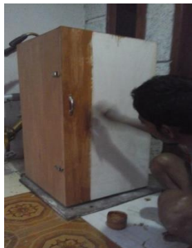
Gambar 2. Proses pewarnaan mesin pengering
