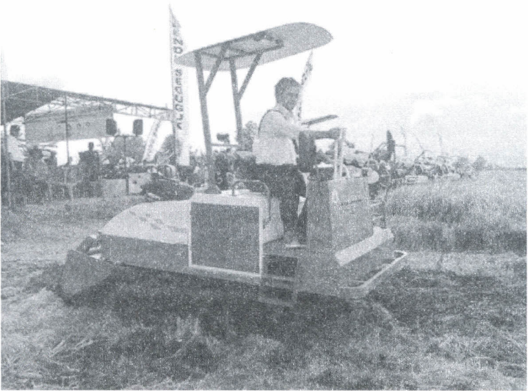
Gambar 73. Traktor amfibi digunakan untuk olah tanah di lahan lebak
