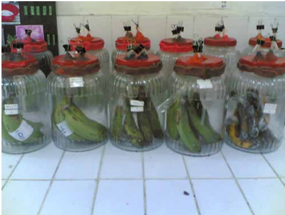
Lampiran 1. Stoples yang digunakan sebagai wadah dalam pengukuran respirasi buah pisang Barangan (Jars used as container on respiration measurement of Barangan banana fruits)
