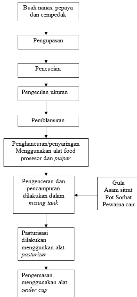
Gambar 1. Diagram alir pembuatan sari buah
