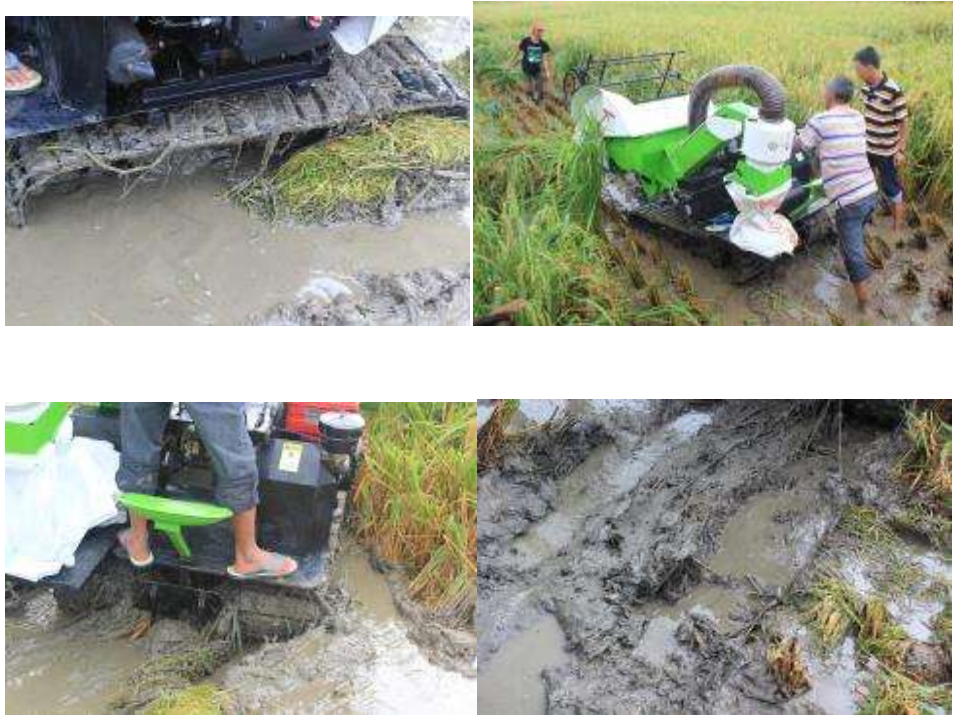
Gambar 7. Kondisi dimana terjadi slip, terperosok dan sisa tanaman tertarik gear box
