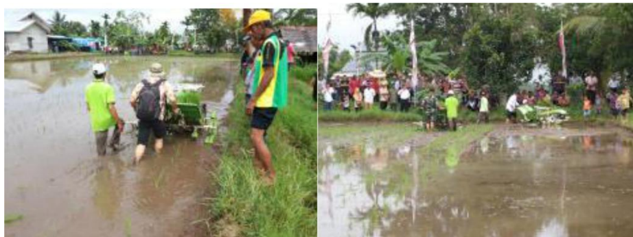
Gambar. 1. Mesin Tanam Indojarwo beroperasi di lahan pasang surut tipe B Kalbar
