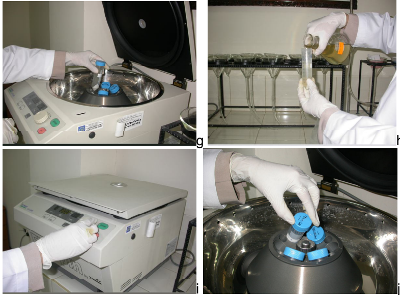
Gambar 11. Ekstraksi sampel akar dengan metode sentrifuge : (a) sampel akar dipisahkan dari tanah; (b) akar dicuci dengan air bersih untuk membersihkan sisa-sisa partikel tanah; (c); (c) akar dipotong-potong kurang lebih 0,5 cm; (d) akar dimaserasi/ dicacah/ diblender untuk memperhalus potongan; (e) akar dicampur dengan larutan kaolin; (f) akar + kaolin disentrifus; (g) hasil sentrifuge diambil dan 2/3 supernatan dibuang; (h) cairan gula dituangkan ke dalam tabung sentrifuge; (i) disentrifus kembali; (j) hasil sentrifuge diambil dan supernatan dituangkan kedalam saringan nematoda Ø 20 µm (625#) selanjutnya nematoda yang terperangkap pada saringan diambil dengan cara menyemprotkan air bersih dan air semprotan ditampung ke dalam gelas Beaker (dokumentasi BBKP Soekarno-Hatta, 2006)
