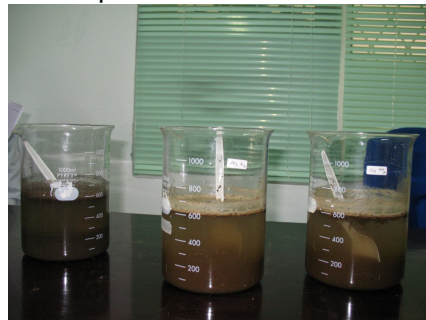
c. 200 gram sampel dimasukkan kedalam gelas beaker + 500 ml air / alkohol 70%, diaduk dan diamkan \pm 10 menit
