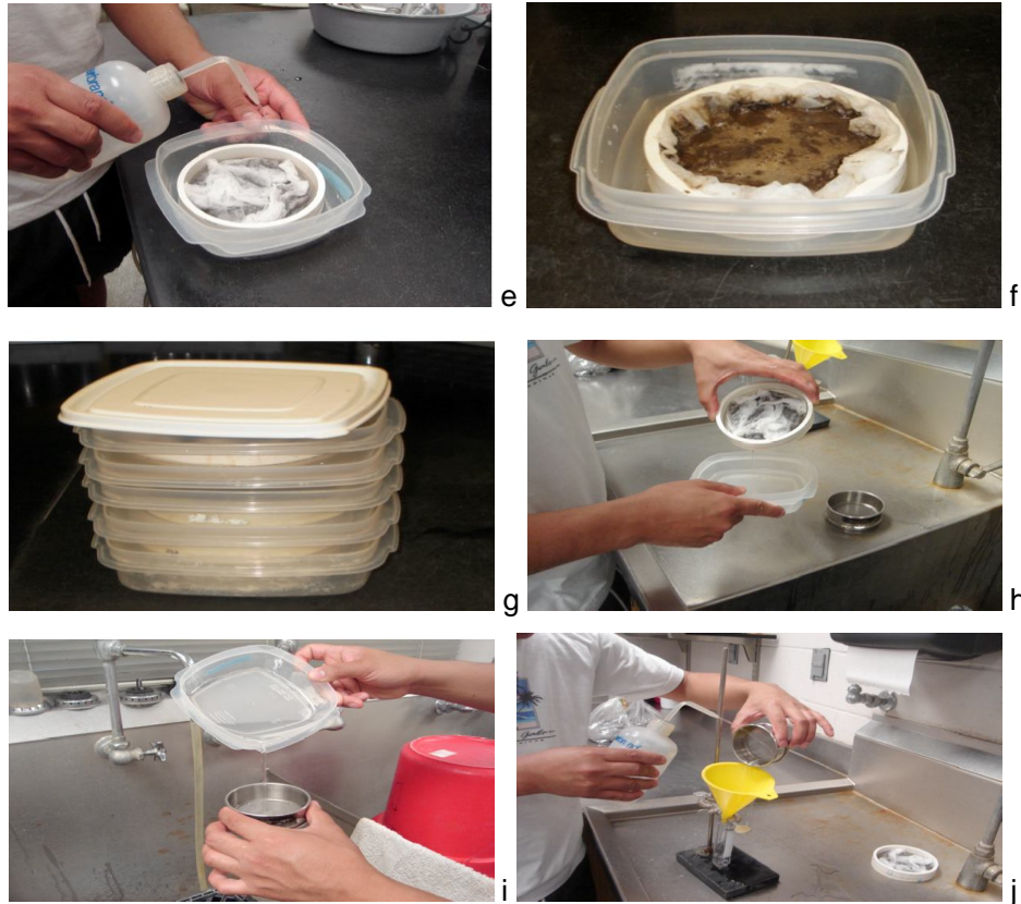
Gambar 9. Proses ekstraksi white head tray : (a) Perangkat white head tray yang dimodifikasi disiapkan; (b) perangkat white head tray disusun seperti pada gambar dan air ditungkan dengan botol semprot sampai menyentuh bagian bawah kasa penahan tisyu; (c) sampel tanah diletakkan pada tisyu; (d) sampel tanah dan pada tisyu diletakkan diatas kasa penahan tisyu pada perangkat white head tray yang telah disusun; (e & f) air dituangkan dengan botol semprot ke dalam nampan sampai seluruh sampel tanah terendam namun tidak sampai melebihi bagian atas nampan; (g) sampel diinkubasikan selama 2x24 jam ; (h) setelah masa inkubasi sampel diangkat dan ditiriskan diatas nampan; (i) cairan dalam nampan (suspensi nematoda) diambil dengan cara dituangkan ke dalam saringan Ø 20 µm (625#); (j) nematoda yang terperangkap pada saringan diambil dengan cara menyemprotkan air dengan botol semprot, dan airnya ditampung pada gelas Beaker kemudian dituangkan ke cawan hitung / cawan Petri (sumber : Govindasamy K., Rich, J.R., Mendes, M.L.)
