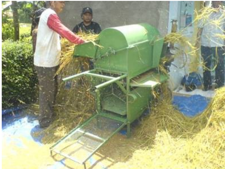
Gambar 2. Pengujian mesin perontok padi tipe Throw-in hasil modifikasi
